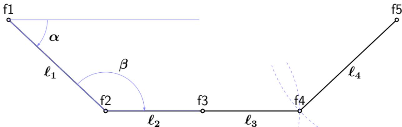
Los parámetros que definen una forma concreta pueden elegirse: en la figura, por ejemplo, podrían ser los ángulos  $\alpha$  y  $\beta$ . Estos dos ángulos, junto con las cuatro longitudes fijas, determinan completamente todas las coordenadas desconocidas de los puntos 2, 3 y 4.
