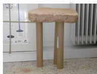
La idea inicial: tres portaplanos soportando una *adoba* como losa. Ciertamente es una estructura inestable: cualquier pequeño desplazamiento horizontal de la losa hubiera desequilibrado el conjunto.
