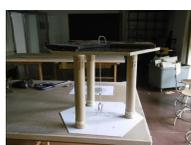
Prueba inicial. En equilibrio bajo el peso de 30kg adicionales. Las columnas se apoyan sobre la base, y la mesa de carga se apoya sobre las columnas. No se usó adhesivo. Una plomada permite asegurar que la carga está centrada.
