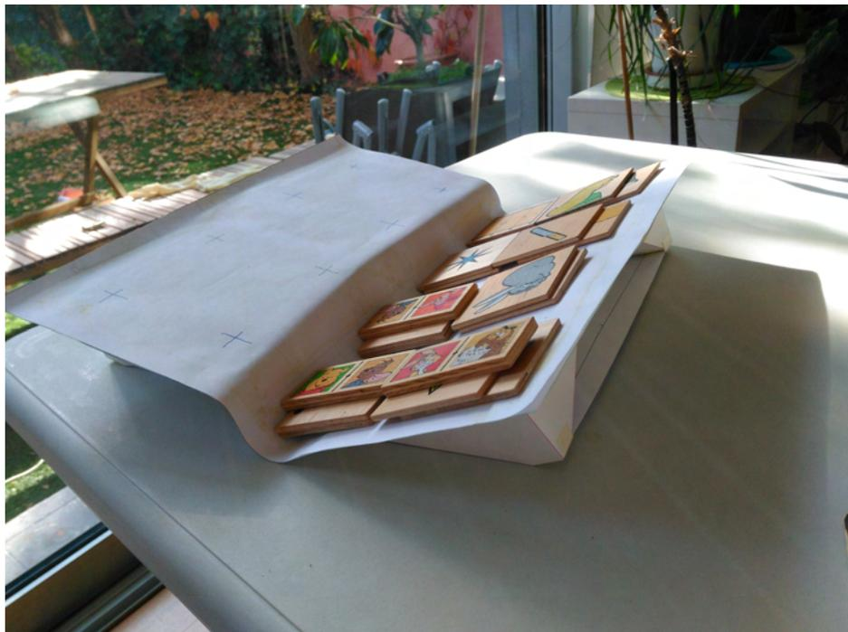
Figura 9: Pero aumentamos la carga un poco más, y la estructura falla de nuevo, doblándose la lámina superior y girando dos de las pirámides.
