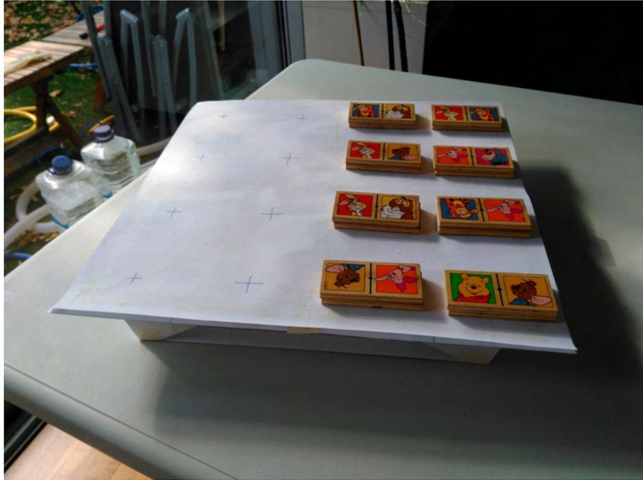
Figura 8: Reforzamos la lámina superior duplicando con una nueva hoja de papel pegada a la original; ahora aguanta algo más de carga que en la versión anterior. (Seguimos con cargas asimétricas, por ser una situación desfavorable.)
