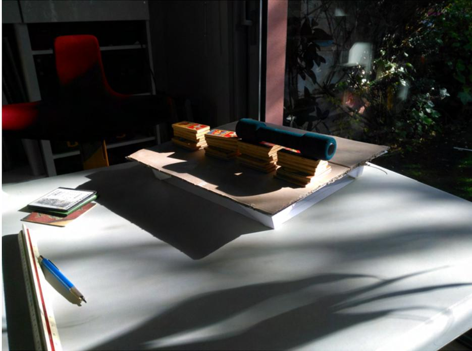
Figura 11: Añadimos al plano superior un elemento capaz de soportar flexiones. Cargamos asimétricamente, y vemos que aumentamos muchísimo la carga soportada. La placa superior de cartón está tan sólo apoyada en el resto de la estructura, sin pegamento
