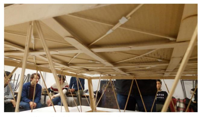
Sin duda, la deformación más llamativa y interesante fue la de los palillos diagonales en las cuatro esquinas de la estructura. Las cargas que transmiten el peso al exterior han doblado completamente cada palillo desde una posición inicial inclinada a una deformación parabólica, que empuja a la mitad hacia adentro arriesgándose a romperlos.
