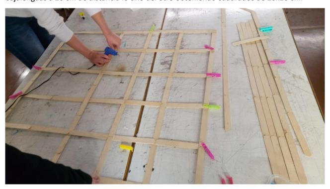
En esta fase de la construcción la utilización de la silicona fue fundamental para unir los palillos sobre todo en los puntos de contacto entre las bajalenguas, en los puntos débiles y en las esquinas.
