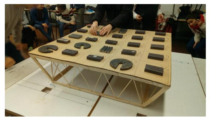
Durante el posicionamiento de los pesos en los diversos cuadrados se evidenció una flexión de las fibras inferiores de la plataforma, especialmente en el centro donde el estrés es mayor. Cargando la estructura, además de la deformación central, también se ha notado el movimiento de los lados laterales de la pirámide troncada hacia el exterior.
