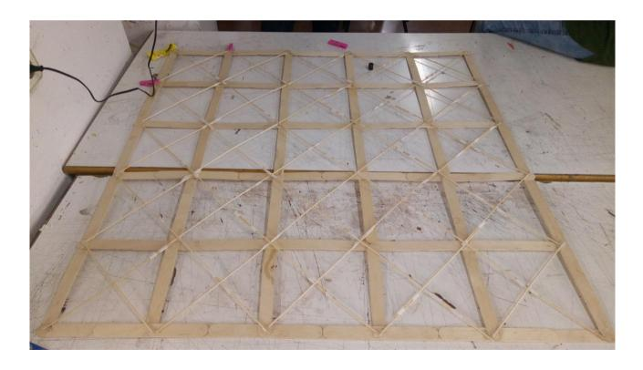
Para la realización de la pirámide troncada, hemos construido perímetros trapezoidales con bajalenguas con base menor, la que apoya al suelo de 80cm y base mayor, que se junta a la base cuadrada, de 1 m. Al interior del trapecio hemos puesto palillos para crear una estructura triangular.
